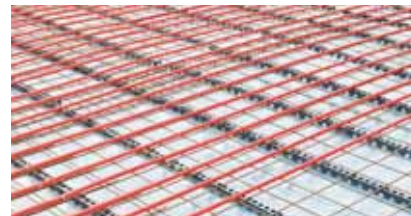
Schéma tepelně aktivovaného betonového stropu s trubkami upevněnými na armaturu
