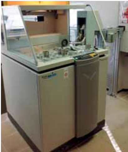
Údaje o chemickém složení suroviny a vyráběného produktu poskytuje rentgenový fluorescenční spektrometr v podnikové laboratoři Lafarge Cement
