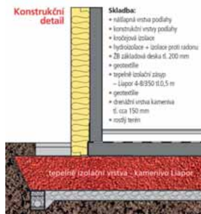
Konstrukční detail zakládání na podsypu z Liaporu
