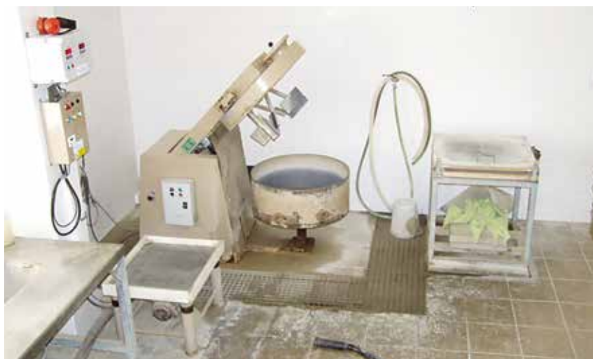
Míchačka na beton a rozlívový stolek v betonářské laboratoři
