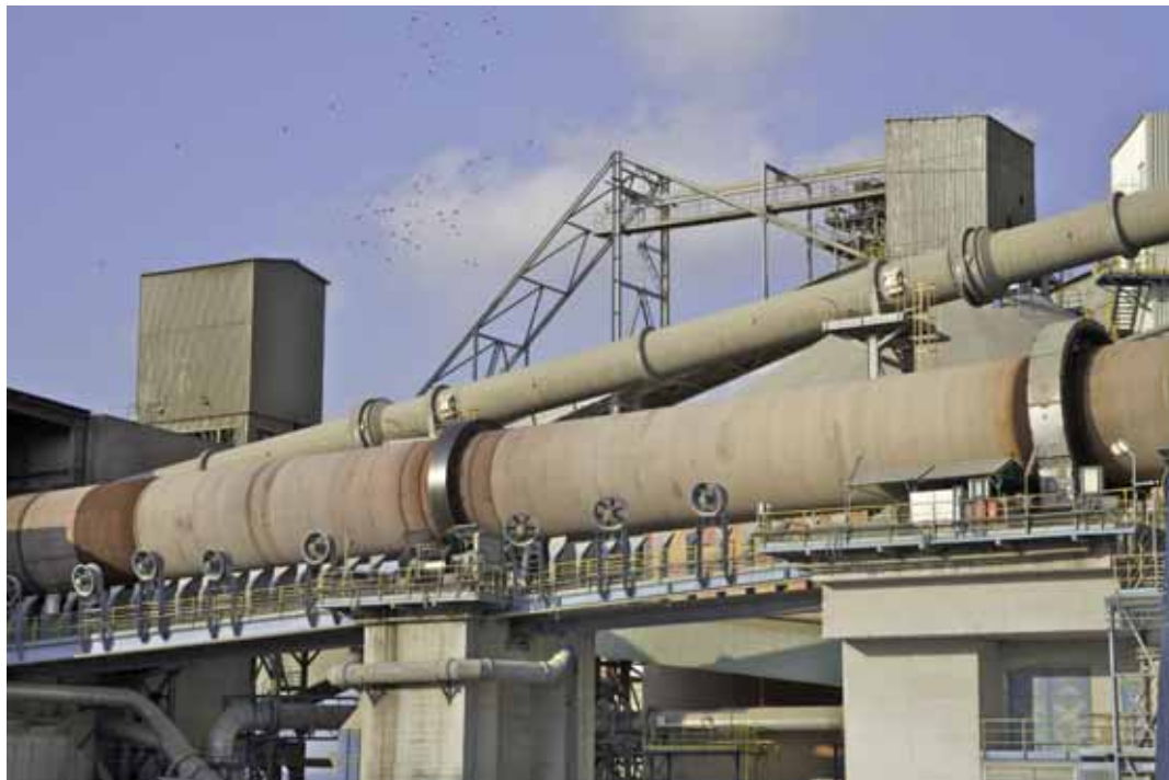
Pecní linka závodu Lafarge Cement, a. s., na snímku Ing. Stanislava Štýse, DrSc.
