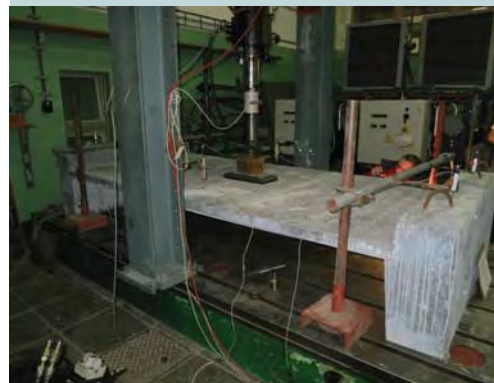
Obr. 5 Zatěžovací zkouška části segmentu
