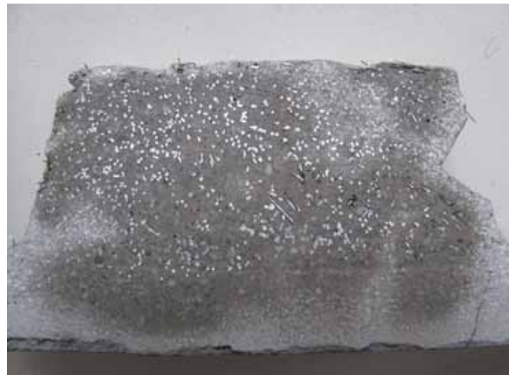
Obr. 2: Nerovnoměrné rozložení vláken po výšce průřezu
