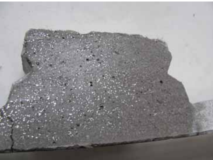
Obr. 1: Rovnoměrné rozložení vláken po výšce průřezu
